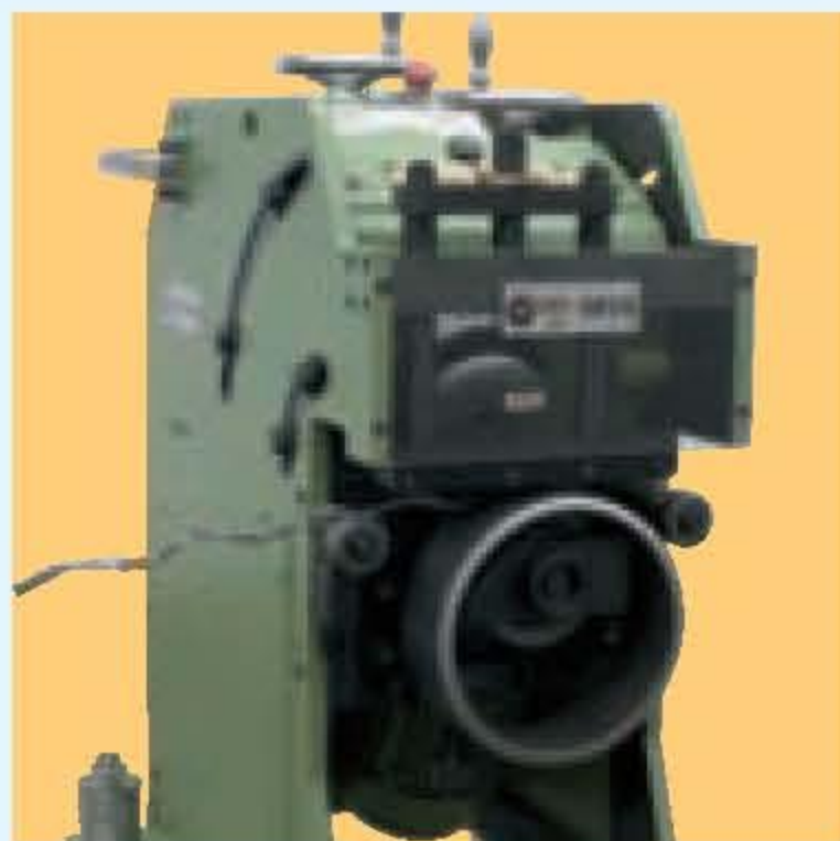
Chaflanado de tubos. Bevelling tubes. Chanfreinage sur des tubes.
