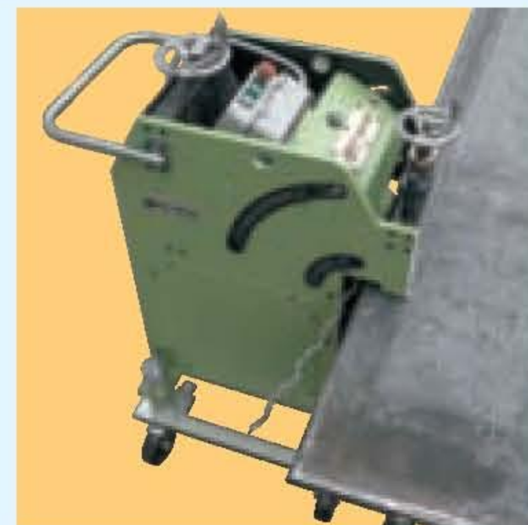
Chaflanado en chapa larga avanzado sobre carro. Bevelling large pieces moving forward on the trolley. Chanfreinage de grandes pièces avançant sur le chariot.
