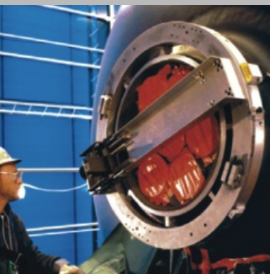
Opcional "Bridge Slide" para tuberías de pared gruesa. Bisel, Bisel compuesto y preparación en J.
