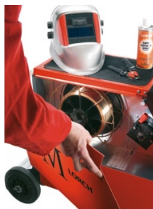
Práctica superficie auxiliar sobre la máquina, así como ergonómico e iluminado recinto de avance de hilo
