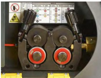
Alimentación profesional de doble ranura mecanismo con 4 rodillos
